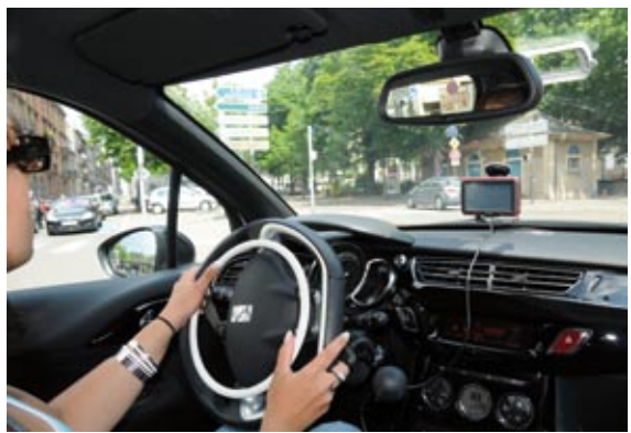
Ergonomisches Fahren: Mit dem Darios Gasring lässt sich der DS3 feinfühlig dirigieren
