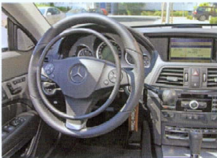
Links: Der Gasring von Kempf ermöglicht eine zuverlässige Handbeschleunigung des Pedals.
